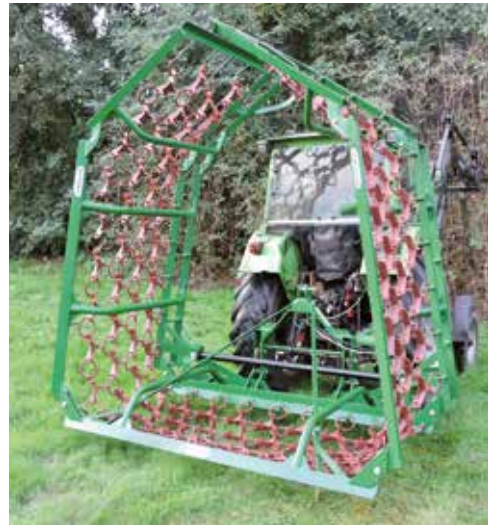
Grünlandegge 8,00 m, 4-reihig, hydraulisch klappbar
