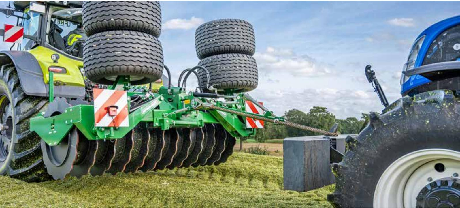
Der beidseitige hydraulische Seitenverschub der Silagewalze erleichtert das Verdichten an den Silorändern und minimiert so zuverlässig das Risiko von Fehlgärungen im Randbereich. Mit ihrem hohen Eigengewicht und der groß dimensionierten Trommel ist sie speziell dafür entwickelt viel Silage schnell im Lagerraum zu verdichten. Das verbessert den Gärungsprozess, erhält den Energiehaushalt des Futters und sichert die Silagequalität.
